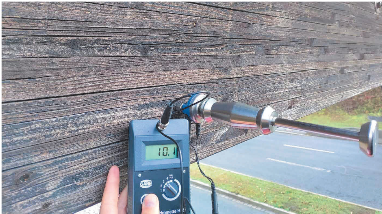
Abbildung 4 beispielhafte Abbildung einer Holzfeuchtemessung am Hauptträger
