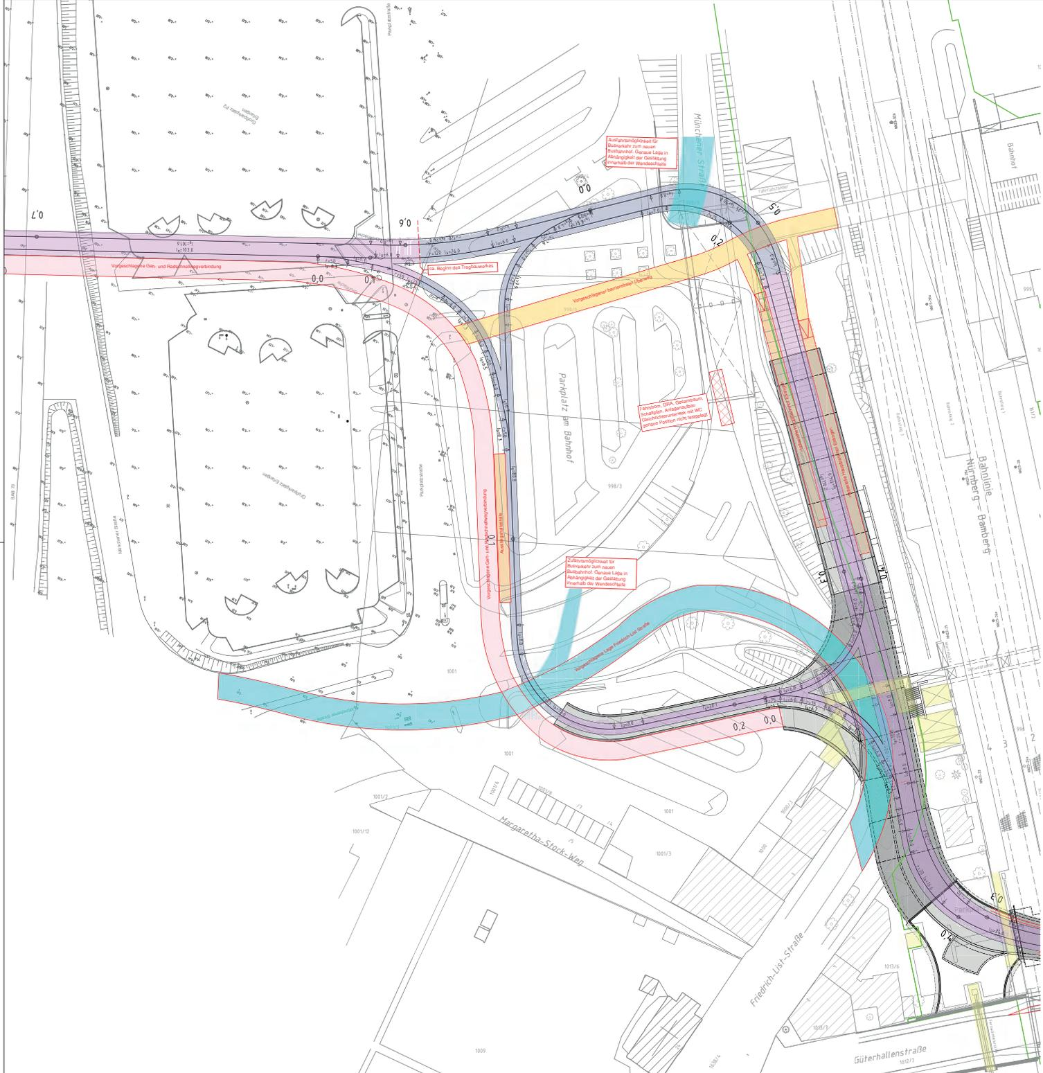
Auffahrtsmöglichkeit für Busfahrzeuge zum neuen Busbahnhof. Genaue Lage in Abhängigkeit der Gestaltung innerhalb der Wendeschleife
