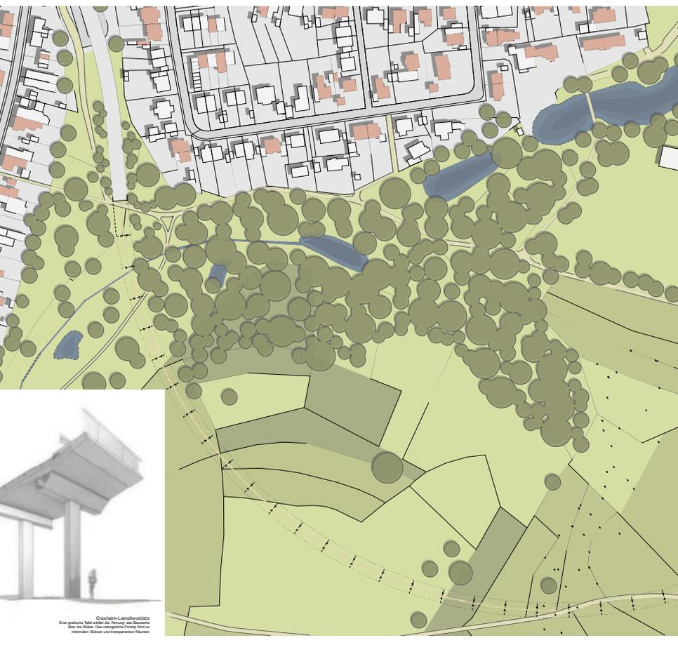
Die Brücke wird als vollintegrale Brücke in Stahlverbauweise ausgeführt. Der Überbau ist folglich über seine komplette Länge monolithisch und biegesteif mit den Unterbauten verbunden. Fugen, Querschnitts-Lager und Übergangskonstruktionen und der mit ihnen einhergehende Wartungsaufwand entfallen komplett.
