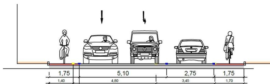
Durch Anpassungen an der Spuraufteilung kann der Schutzstreifen in Fahrtrichtung Innenstadt im genannten Bereich nun durchgehend markiert werden.
