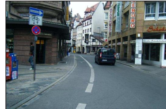
Abb. 2 Radfahrstreifen gegen Einbahnrichtung (Nürnberg)
