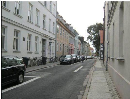
Abb. 10 Ausweichstelle für Begegnungen in einer Einbahnstraße mit gegenläufigem Radverkehr (Greifswald).
