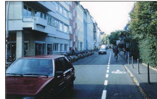
Abb. 3 Schutzstreifen gegen Einbahnrichtung (Bonn)
