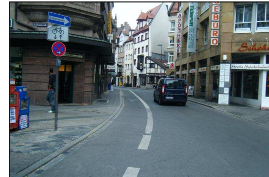
Abb. 2 Radfahrstreifen gegen Einbahnrichtung (Nürnberg)
