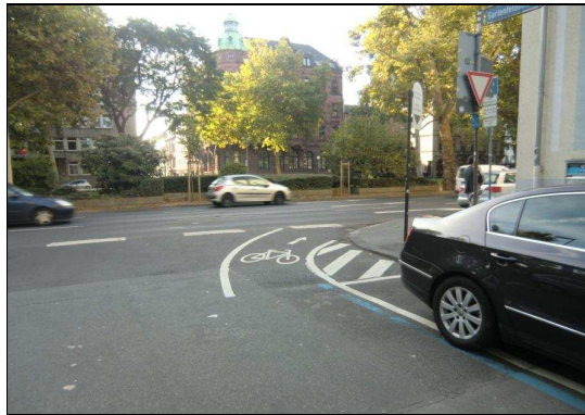
Abb. 8 Ausfahrtpforte an einem vorfahrtsregulierten Knotenpunkt (Mainz)
