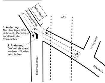
Aus Rechtsabbiegen wird Geradeausfahren! Der Verkehr wird so mit geringem Aufwand quasi automatisch auf das Erlanger-U geleitet.
