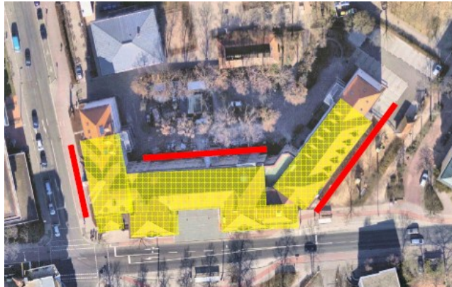
Abb. 4: Umfang der Fassaden- und Dachsanierung
