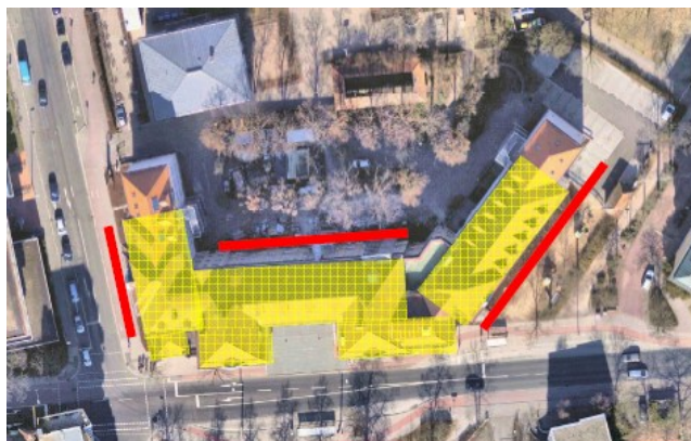
Abb. 4: Umfang der Fassaden- und Dachsanierung
