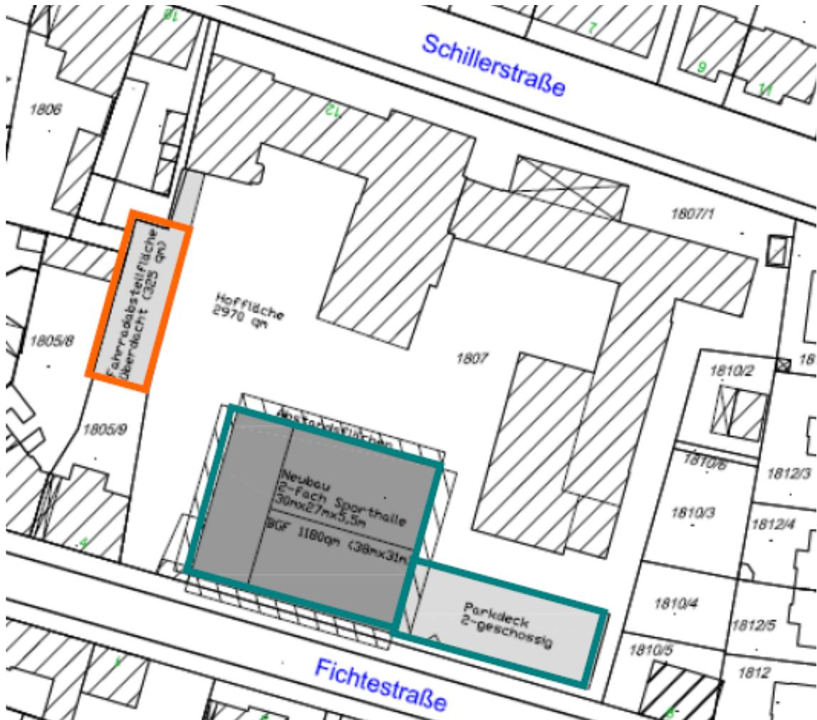
Abb. 5: Lageplan mit Darstellung der 2-fach-Sporthalle mit Parkdeck (grün eingerahmt) sowie eines Fahrradunterstandes (orange eingerahmt)
