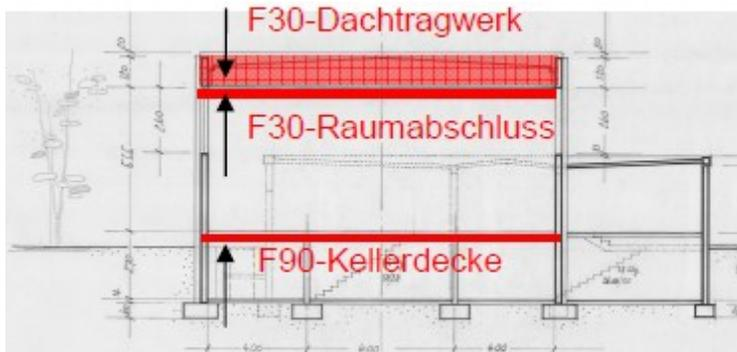
Abb. 4: Schnitt durch 1-fach-Sporthalle
