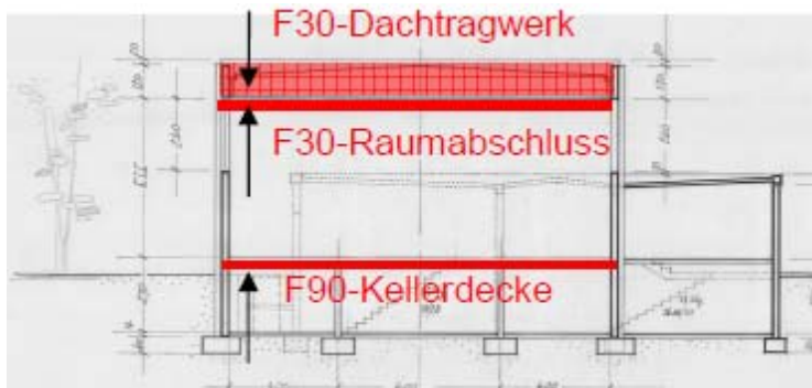
Abb. 4: Schnitt durch 1-fach-Sporthalle
