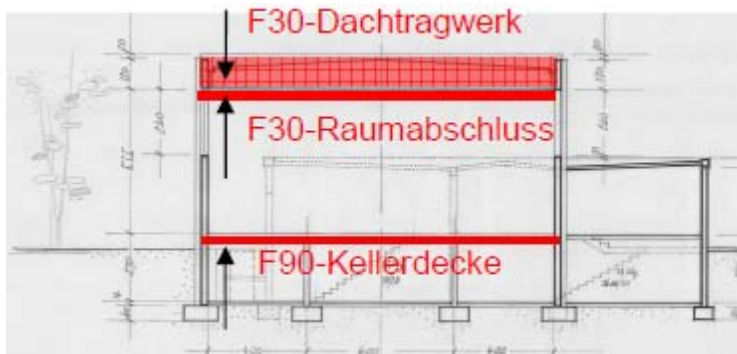
Abb. 4: Schnitt durch 1-fach-Sporthalle
