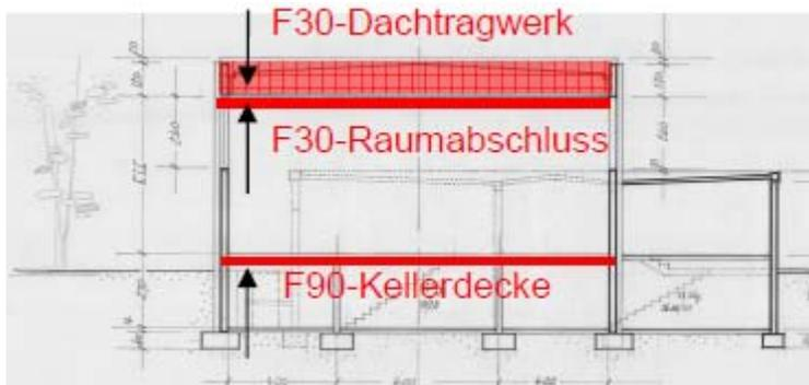
Abb. 4: Schnitt durch 1-fach-Sporthalle
