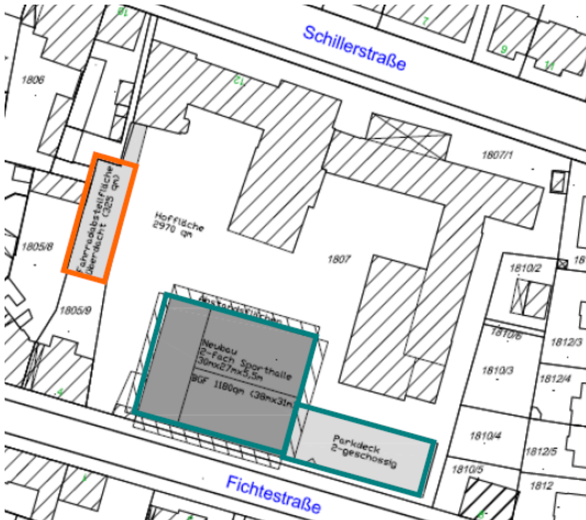
Abb. 5: Lageplan mit Darstellung der 2-fach-Sporthalle mit Parkdeck (grün eingerahmt) sowie eines Fahrradunterstandes (orange eingerahmt)
