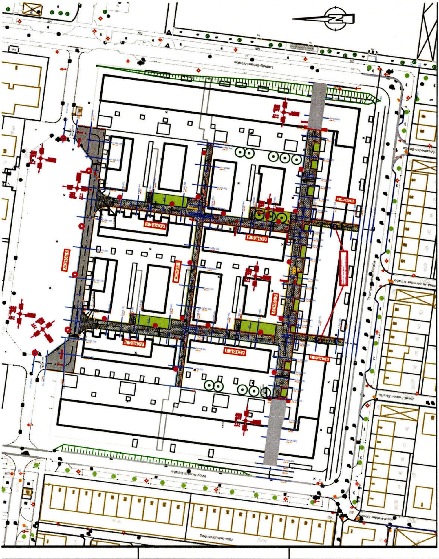
Entlang der Weisendorfer Straße wird das Straßenwasser einerseits über Straßenabläufe gesammelt und den beiden neu herzustellenden Entwässerungsmulden westlich und östlich des Seebachs zugeführt. Hierfür wurde eine Wasserrechtliche Erlaubnis beantragt. Zum anderen wird im weiteren Verlauf der Weisendorfer Straße in Richtung Heßdorfer Weg das Oberflächenwasser in die städtische Kanalisation eingeleitet.
